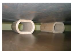
圧力試験機で行われた耐圧試験では長さ 200mm の桁で、およそ 500kg の耐圧強度を記録。1100×1100mm では、およそ 5000kg の耐圧強度を誇ります。
